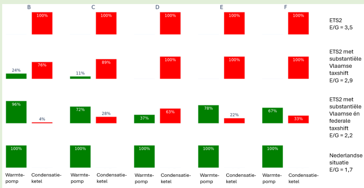
Figure. Part des logements équipés d'une pompe à chaleur ou d'une chaudière à condensation au gaz présentant le TCO le plus bas par label CPEet par rapport au prix de l'électricité et du gaz (E/G) pour une prime moyenne de 3 000 euros (VITO, 2025)
